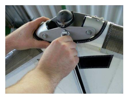
Danach wird der Schnappkarabiner des Querrohrsicherungsseils in der Lasche am Querrohr eingehängt und anschließend der Reißverschluss des Doppelsegels zugezogen.
