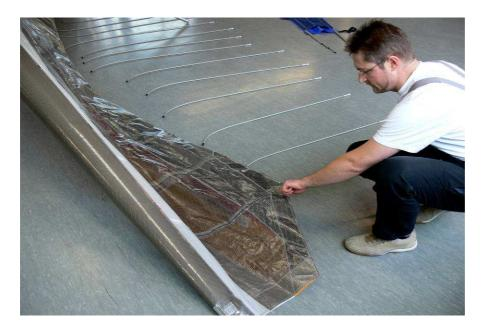
Rote Lattenzahlen = linke Seite, grüne = rechte Seite (in Flugrichtung gesehen). Im Lattenköcher sind für die linke und rechte Segelhälfte getrennte Lattenfächer angeordnet. Nachdem Sie die Obersegellatten eingeschoben haben, können Sie das Gerät aufrichten und spannen.
