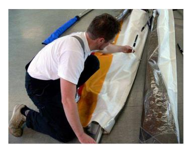
Schieben Sie die Flügelrohre dann von hinten in das Segel. Führen Sie den Swiveltip an der Reißverschlussöffnung des Doppelsegels wieder nach außen und schieben Sie das Rohr mit nach oben zeigendem Swiveltipseil in das vordere Flügelrohr. Der Swiveltip schwenkt dabei nach hinten. Drücken Sie die beiden Schnapper ein und achten Sie darauf, dass die beiden eingedrückten Schnapper im vorderen Flügelrohr ausrasten.
