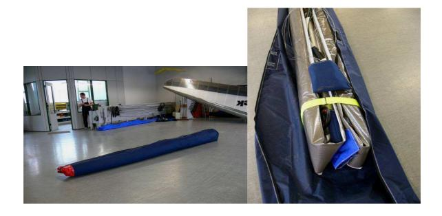
Legen Sie den kurzgepackten Kite mit dem Trapezbereich nach oben zeigend auf den Boden. Öffnen Sie den Reißverschluss und legen Sie den Lattenköcher und die beiden hinteren Flügelrohre zur Seite. Falls Sie mit nicht teilbaren Rädern fliegen, schieben Sie vor der Montage der Trapezbasis die Räder auf die Speedbar.
