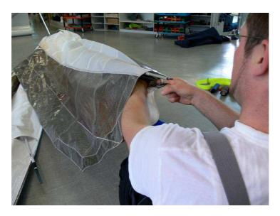
Ziehen Sie anschließend die breite schwarze innere Bandschlaufe am Ende der Segelanströmkante über das abgeflachte Kunststoffendrohr des hinteren Flügelrohres. Am Segelende befindet sich eine graue Hilfsschlaufe die diesen Montageschritt erleichtert. Schließen Sie die Klettbandhälften am Innensegel zur Sicherung der Bandschlaufe gegen evtl. Abrutschen vom Flügelrohr beim Transport.
