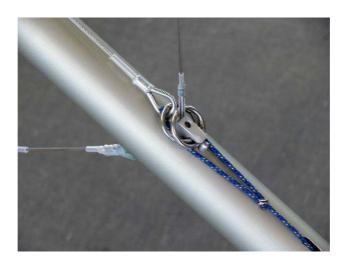
Danach wird der Stahlring des hinteren Oberriggs ebenfalls dort eingehängt. Prüfen Sie, ob der Schnapper hinter den beiden Ringen ausgerastet ist.
